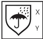
Y = Résistance évaporative, c'est-à-dire capacité d'évacuation de la vapeur d'eau créée par la transpiration à la surface du vêtement (classes 1-3, classe la plus élevée 3)
