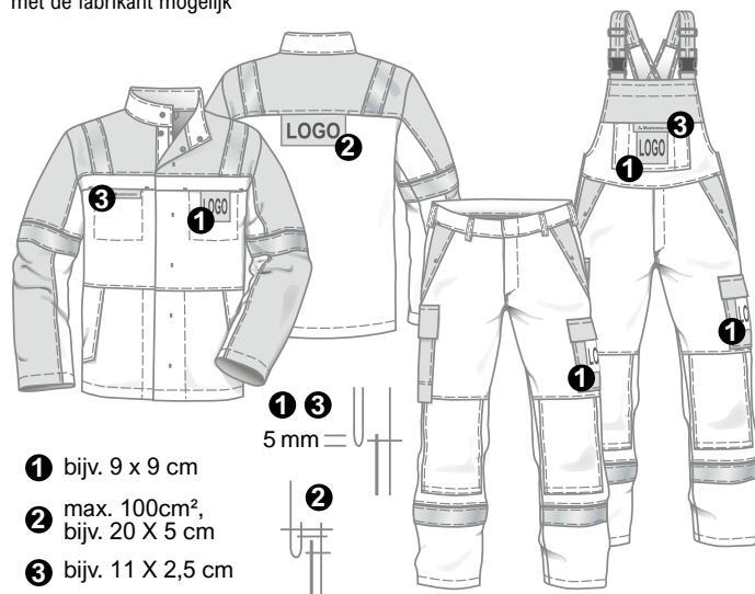
De volgende norm (EN ISO 11612:2015) legt de prestatie-eisen aan de beschermende kleding vast die bestaat uit flexibele materialen en bedoeld is om het lichaam te beschermen. De beschermende kleding beschermt de drager tegen hitte en/of
