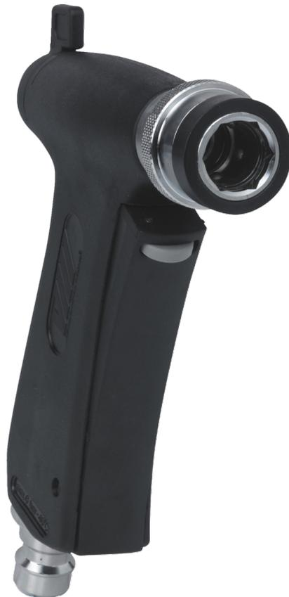
Dies ist ein Ersatzteil für das Schaumreinigungsset (9305x). Der Wasserdruck dieser Pistole lässt sich leicht einstellen, und der Auslösegriff hat eine Schließ- und Öffnungsvorrichtung, um versehentliches Sprühen zu vermeiden. Die Pistole hat eine 1/2"-Düse, die Sie an einen Schlauch mit einer 1/2"-Q-Kupplung anschließen können.
